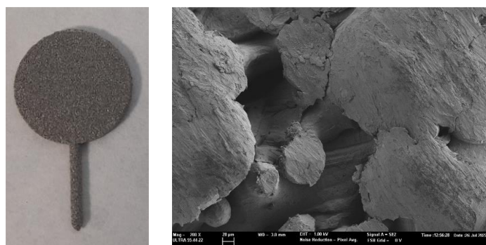
Figura 12. Estructuras de las superficies de soportes de titanio fabricados con tecnología PBF-EB.
